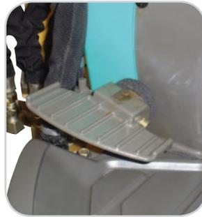
Ausklappbare Pedale (Pedal für den Zusatzkreis sowie das Pedal für das Ausleger-Schwenken)
