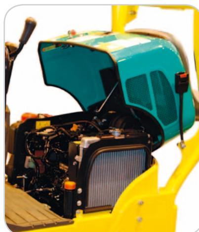
Totale Öffnung der Motorhaube für problemlosen Zugang zu allen Wartungspunkten. Einfach demontierbaren Seitenschutz aus Stahl.
